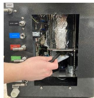
80 時間の操作の終了時に初期メンテナンス手順 (上記のステップ 1~10) を繰り返すと、画面に Adjust packing nut (パッキンナットを調整してください) というメッセージが自動的に表示されます。
