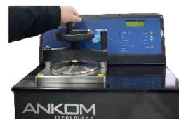
10. キーパッドの START（開始）を押します。溶液はまず、粗繊維酸バルブを通してベセル（釜）に流れ込みます。
